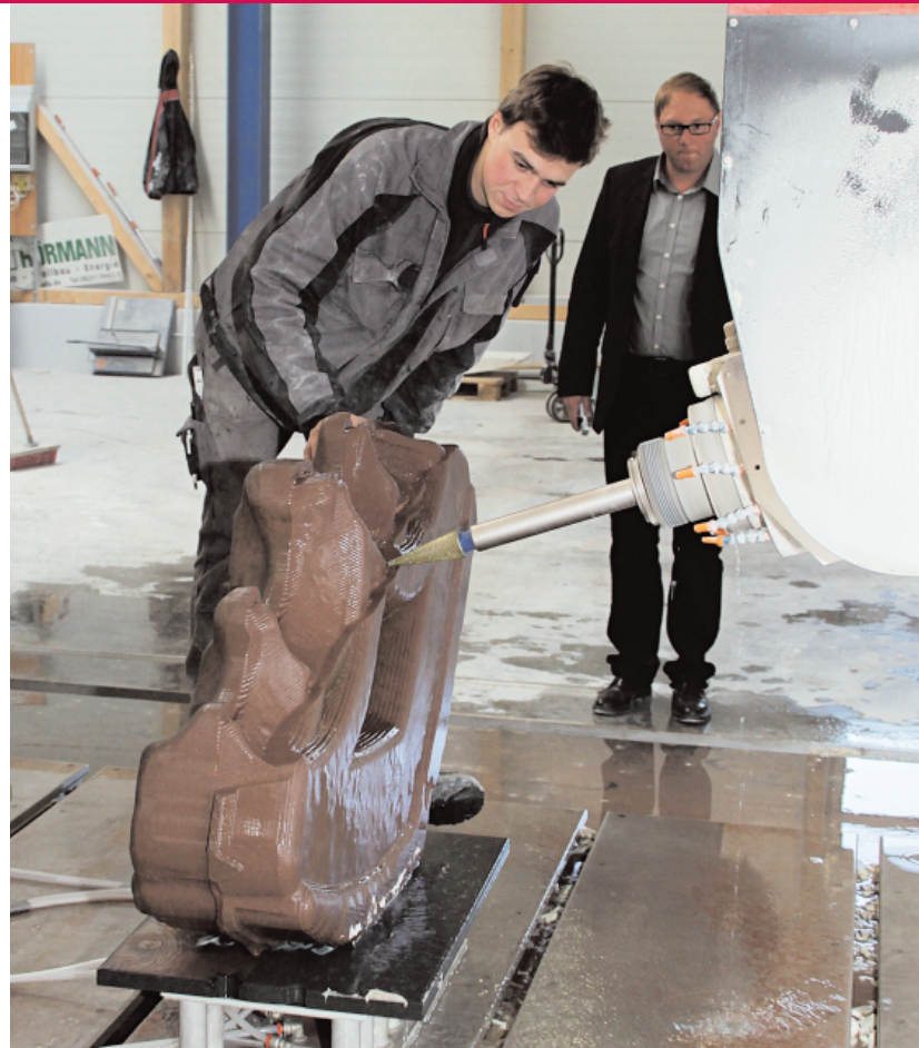
Kontrolle eines Maßwerkteils aus rotem Sandstein. Gearbeitet wird mit einem Offset im Millimeterbereich, um genug »Fleisch« für die Nacharbeit nach Kundenwunsch zu haben.
